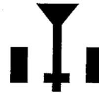
d) Nakon stvrdnjavanja, gotovi odlivci se odvajaju od ulivnog sistema.
